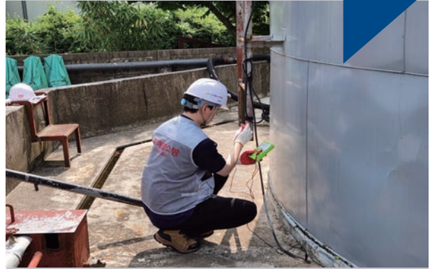
접지 저항 측정
